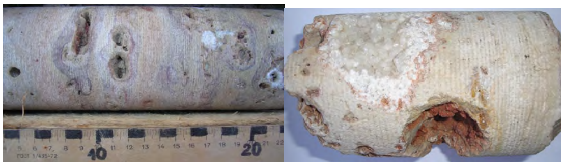
Joonis 2.9. Kavernoosne peenekristalliline dolokivi.
