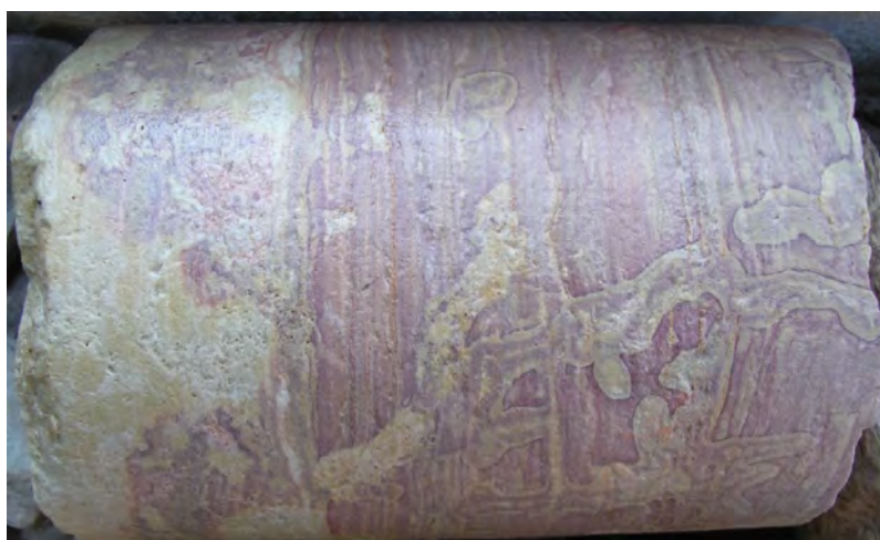
Joonis 2.10. Mudasööjakäikudega kiht, mis markerib Pskovi kihistiku ja samas ka kasuliku kihi lamamit.
