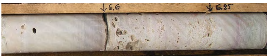
Joonis 2.7. Kavernoosete vahekihtidega valdavalt tihe dolokivi. Puurauk 12A
