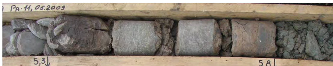
Joonis 2.5. Uuringuruumi lõunapiiril algab aluspõhja läbilõige savika dolokivi või domeriidiga.
